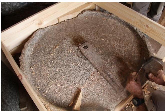
Figura 21 – Pormenor da mó *dormente* e da nova *camba* em madeira. Fonte: Autores
