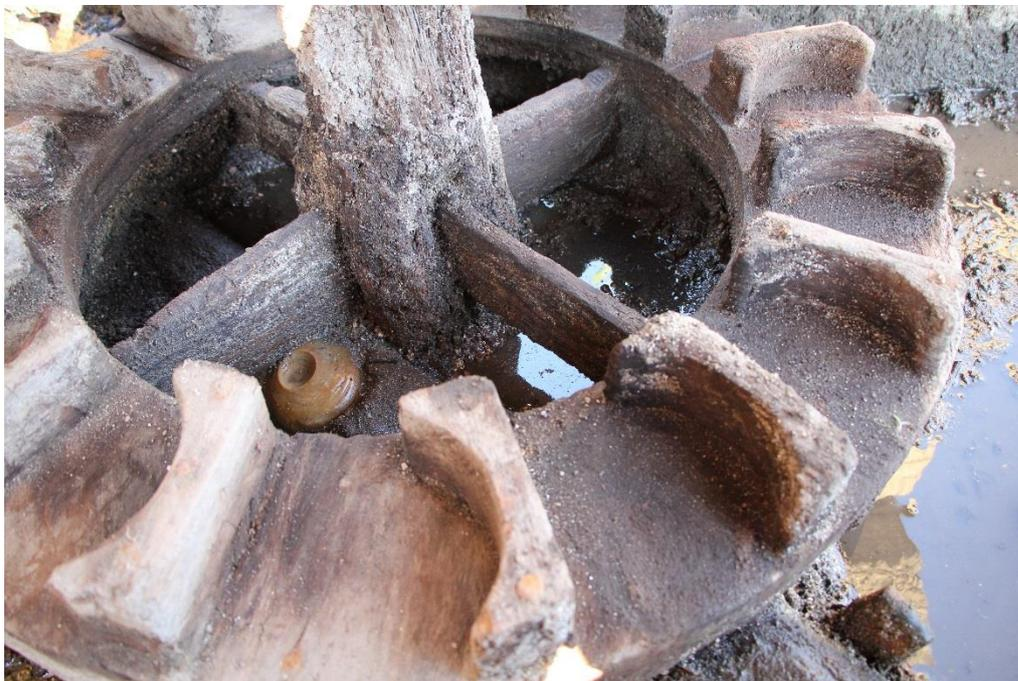
Figura 24 – Pormenor do mecanismo motor do Moinho do Ribeiro antes dos trabalhos de restauro (atente-se na presença da *rela* junto ao *rodízio de tacos*). Fonte: Autores
