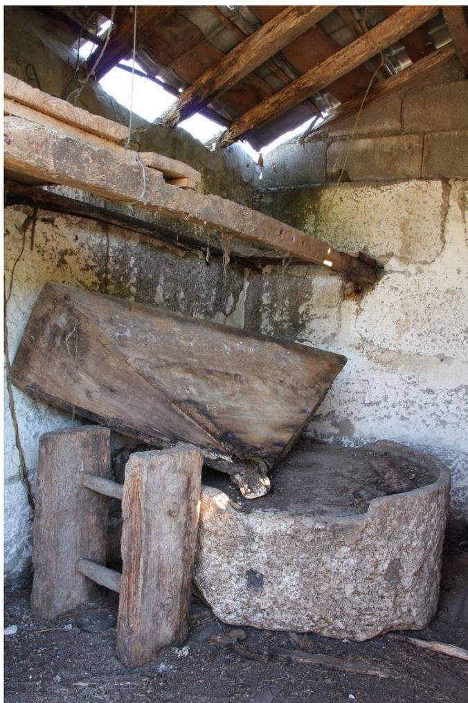
Figura 20 – Estado do mecanismo de moagem à data do seu inventário. Fonte: Autores
