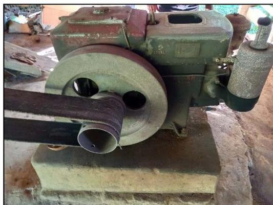
Figura 13 - Parte do motor que movimentava a moenda. Fonte: Autores.
