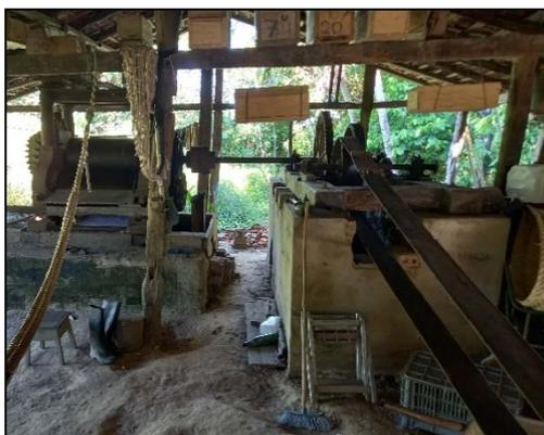
Figura 14 - Vista da mesa de moagem adaptada a motorização. Fonte: Autores.
