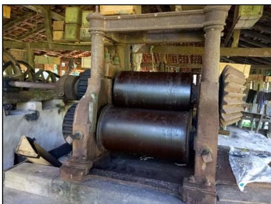
Figura 8 - Cilindros de moagem. Fonte: Autores.
