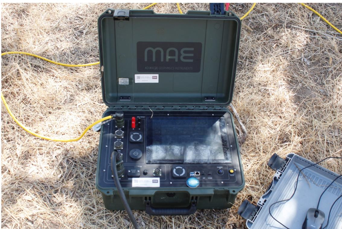
Fig.6 : Georesistívmetro com CPU integrado e monitor (modelo X612EM+), utilizado na prospeção geoeétrica. Foto: F. Coimbra.
