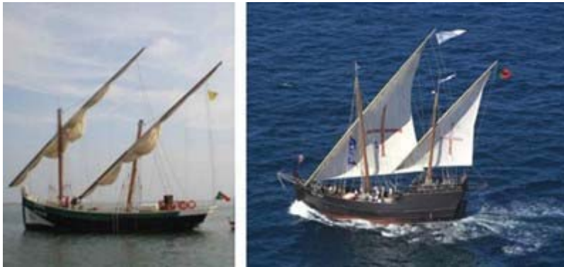
Figura 5 - Comparação da silhueta: casco e vela latina no Caíque de Olhão (esquerda) e na Caravela “VERA CRUZ” (direita). Fonte: Fotografia de José Manuel Carmo, desenhador Naval do Estaleiro Samuel & Filhos de Vila do Conde, construtor da réplica, obtida no Cabo Carvoeiro, em Peniche, em 2000. Arquivo Museu Municipal de Esposende.
