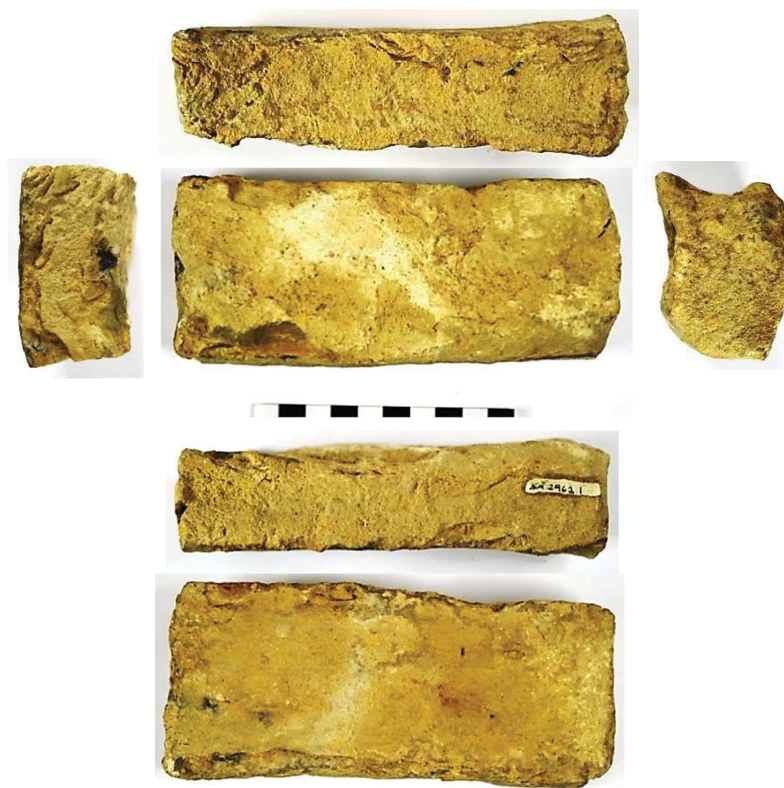
Figura 9. Tijolo MM2962.1, com deformação resultante de técnica de manufatura. Fonte: Maria Oliveira, LACOR, 2016
