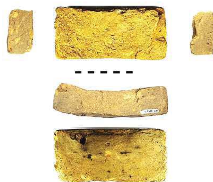
Figura 3. Tijolo MM3196.1, com deformação em arco. Fonte: Maria Oliveira, LACOR, 2016
