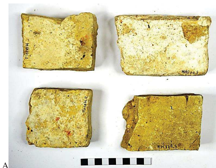
Figura 5. Tijolo MM874.5: dimensões (comprimento x largura x altura): 14,4cm x 6,5cm x 3,4cm; índice largura/comprimento: 45,13; peso: 559 gramas; volume: 318,24cm 3 ; cor: 2.5Y7/4 pale yellow (cartela de cores Munsell para solos); manufatura: manual; dados arqueológicos de contexto: R. Madre de Deus, meio fio, frente Chante Clair (5peças); ausência de gráfico de fluorescência de raio X. Fonte: Maria Oliveira, LACOR, 2016
