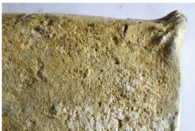
Figura 8. Tijolo MM2092.4. A, detalhe de lado com restos de argamassa de cal; B, detalhe de lado com dobras de manufatura; C, detalhe de aresta, vista por uma base, com sinal de apreensão digital durante a manufatura. Fonte: Maria Oliveira, LACOR, 2016
