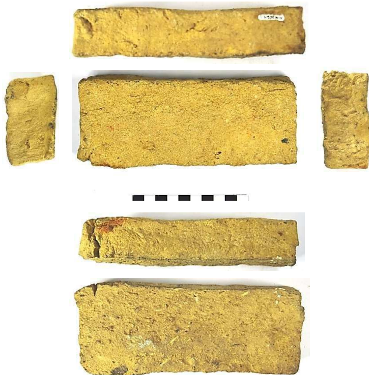
Figura 11. Tijolo MM3024.1, com deformação e fratura durante a técnica da manufatura. Fonte: Maria Oliveira, LACOR, 2016
