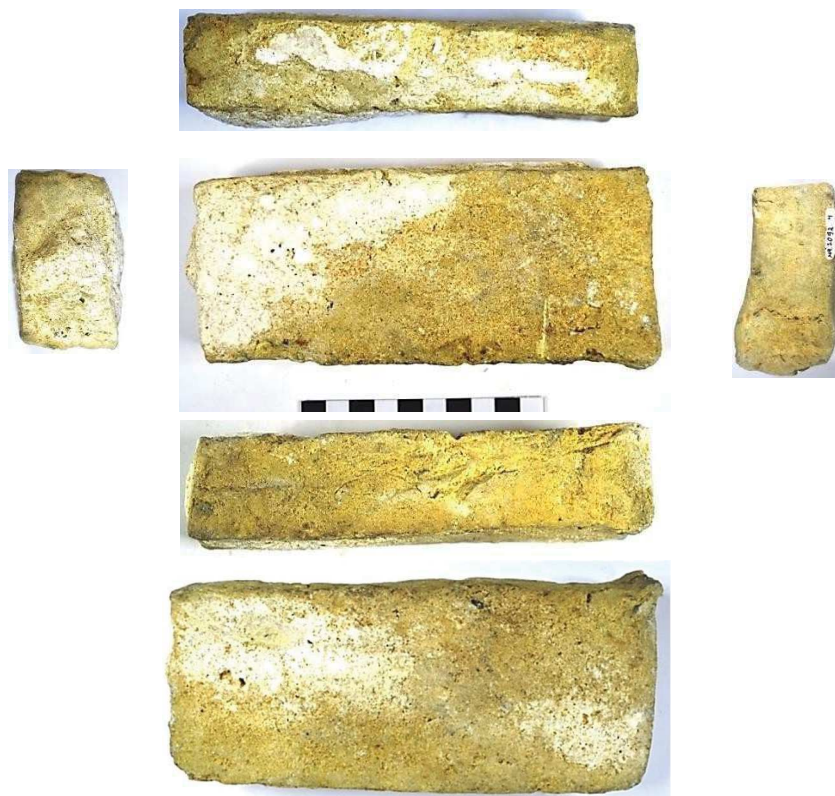
Figura 7. Tijolo MM2092.4; dimensões: 16,8cmx7,3cmx3,5cm; índice largura/comprimento: 43,45; peso: 926 g; volume: 429,24 cm 3 ; cor (Munsell): 2.5Y7/4 pale yellow; manufatura: manual; dados arqueológicos: M2, centro 1D (6 peças); apresenta gráfico de fluorescência de raios X. Fonte: Maria Oliveira, LACOR, 2016
