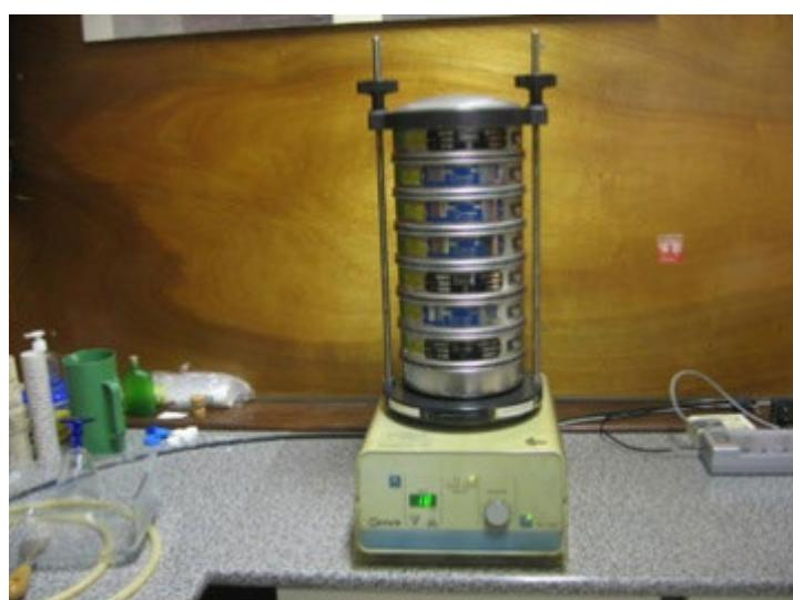
Figura 5. Coluna de peneiros do laboratório de sedimentologia do IPMA
