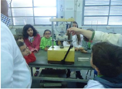
Figura 3: Ensaio de resistência à flexão
