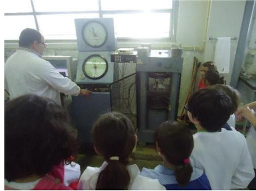
Figura 4: Ensaio de resistência à compressão
