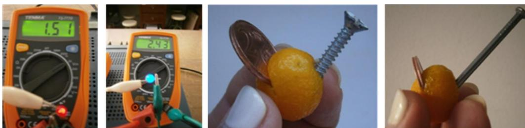
Figura 3: Diferentes ddp mínimas para acender os LEDs vermelho e azul.
