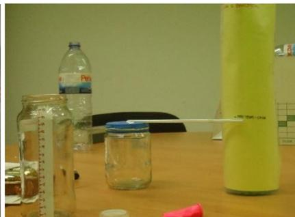
Figura 3: (a) O Barómetro aneróide e a pressão atmosférica (b) Pluviómetro caseiro (c) Pluviómetros barómetro caseiros (da esquerda para a direita)
